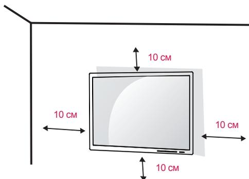
Чтобы установить монитор на стену, прикрепите кронштейн для настенного крепления (дополнительная деталь) к задней части монитора.
