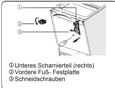
7. Ersetzen Sie das untere Scharnierteil auf die linke Seite und befestigen Sie es mit den speziellen
