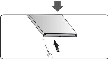
6. Legen Sie den Kühlschrank auf die weiche Schaumstoffverpackung oder auf ein ähnliches Material. Entfernen Sie beide einstellbaren Bodenfüße und entfernen Sie die vordere Fußplatte und das untere Scharnierteil, indem Sie die speziellen Flanschschneidschrauben abschrauben.
