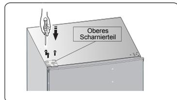
10. Montieren Sie die Schraubenlochabdeckung in der oberen rechten Ecke des Kühlschranks. Montieren Sie die obere Scharnierabdeckung (in der Plastiktüte) auf der linken Ecke. Setzen Sie die andere obere Scharnierabdeckung in die Plastiktüte.
