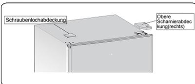
2. Lösen Sie spezielle Flanschschneidschrauben, die zur Befestigung des rechten oberen Scharnierteils verwendet werden, durch einen 8mm Steckschlüssel oder einen Schraubenschlüssel (Bitte tragen Sie die obere Tür mit der Hand, wenn Sie es tun).
