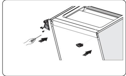
8. Bringen Sie die Tür in die Grundstellung, stellen Sie das untere Scharnierteil ein und richten Sie die Scharnierachse in das untere Loch der Tür ein.
