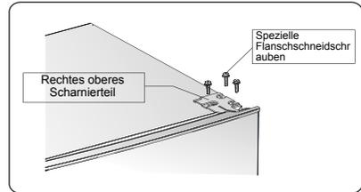
3. Entfernen Sie die obere Scharnierachse, bewegen Sie sie auf die umgekehrte Seite und ziehen Sie sie fest an, und legen Sie sie dann an einen sicheren Ort.
