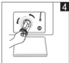
Развийте филтъра чрез въртене в обратна посока на часовниковите стрелки
